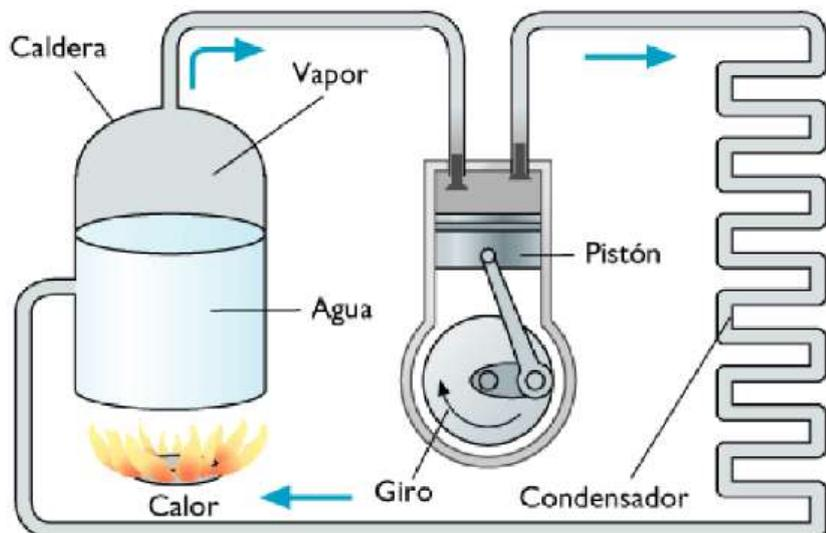
*Esquema del funcionamiento de una máquina de vapor.*
