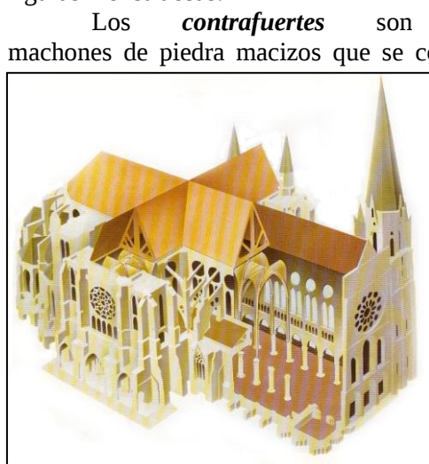
12. Esquema de la catedral de Chartres donde vemos todos los elementos constructivos.
