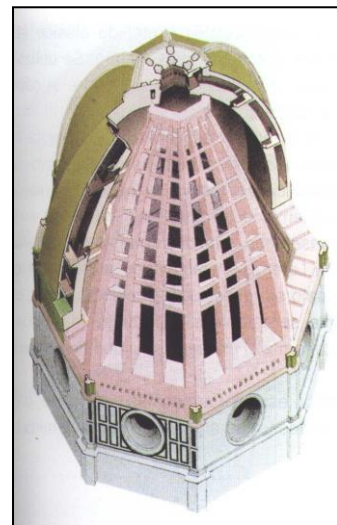
6. Esquema de la construcción de la cúpula.
